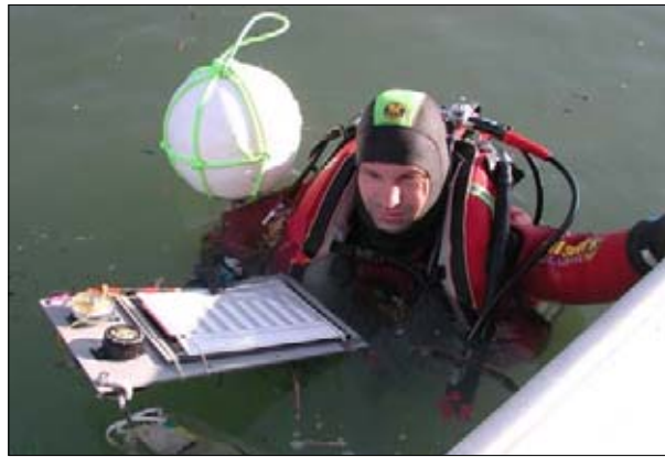
Taucher nach Abschwimmen eines Tauch-Transektes mit Positions- und Rettungsboje, Protokolltablett mit Erfassungsblatt, Tiefenmesser, Kompass sowie Netz für die Entnahme von Pflanzenproben.
